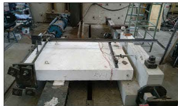
b. 楼梯端部节点试验
