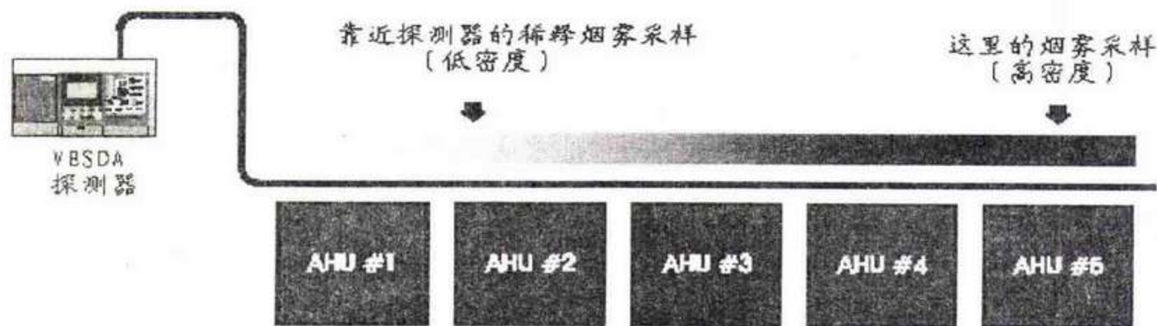
图 29：经过几个空气处理单元后烟雾稀释
