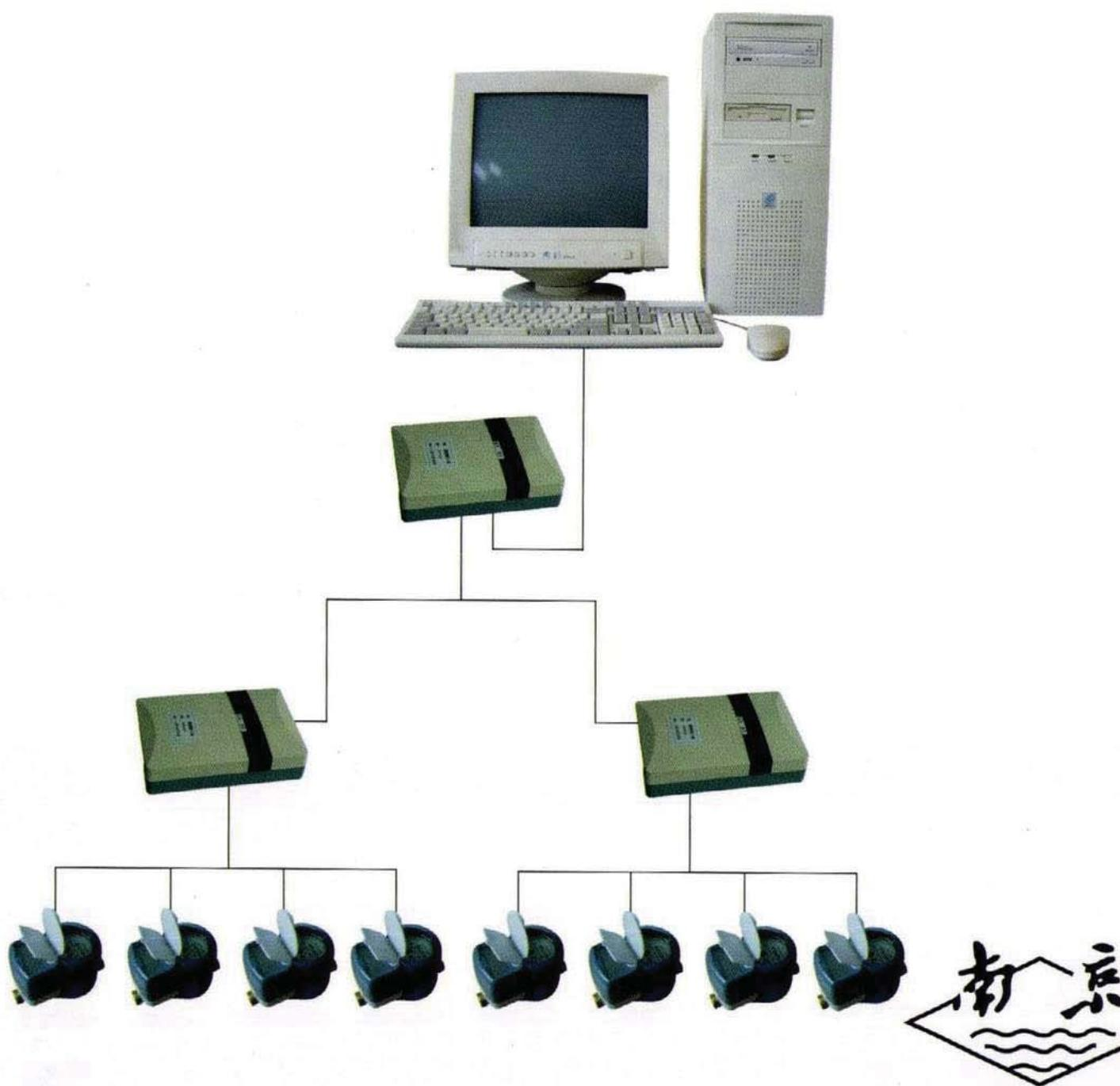
一个集中器可以挂接 100 只转接器，一只转接器可以接 100 只水表。总线通讯距离达到 1500 米。
