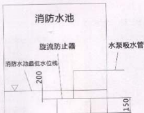
已安装旋流防止器的 水池内部最低有效水位
