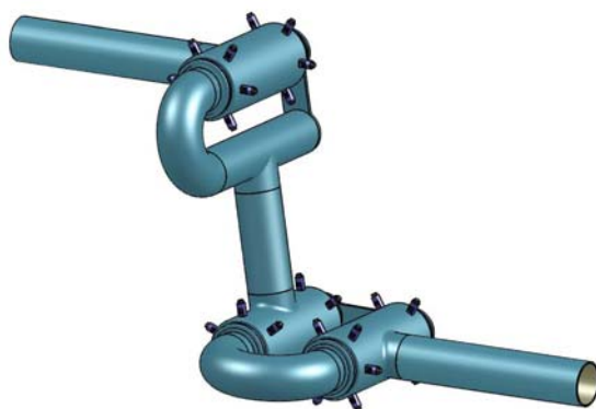
图 4-7 单轴、双轴旋转组合补偿器安装
