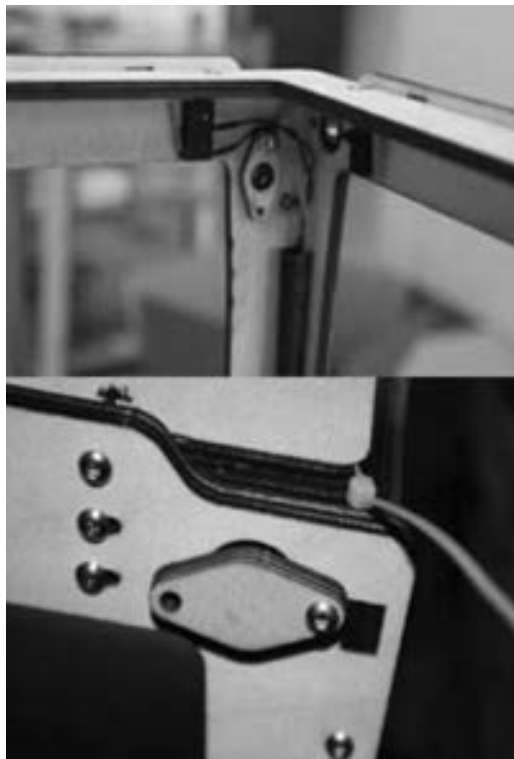
附录图 15 安装轴承帽和轴承挡片
