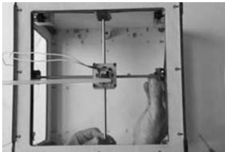
附录图 24 两根轴杆的两端分别插入滑块中
