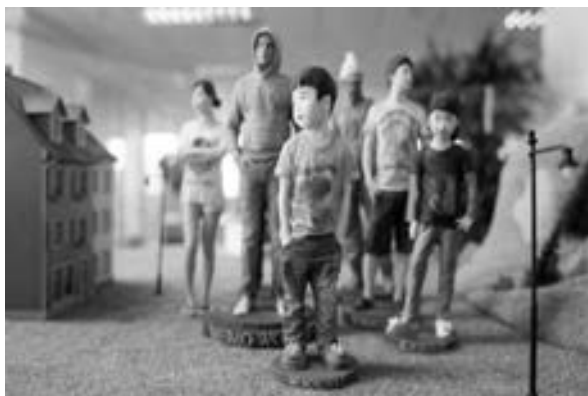
图 2-21 采用 3DP 技术打印全彩色石膏模型（图片来源：百度贴吧）
