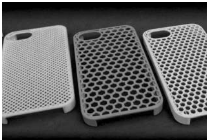
图 3-3 几种不同的填充类型（图片来源：3D Matter）
