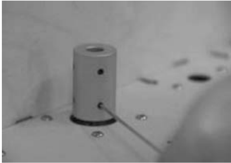
附录图 13 安装联轴器
