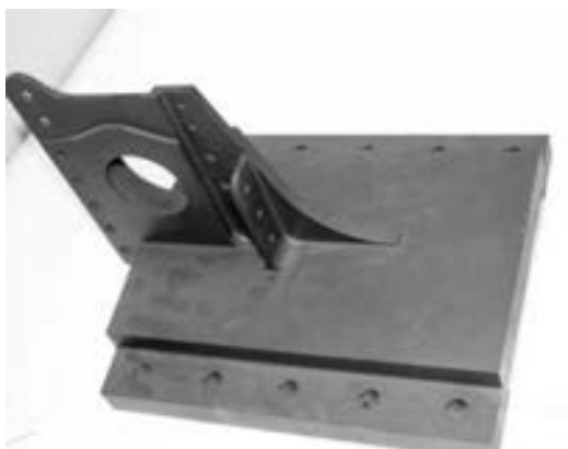
图 2-18 激光直接制造成型钛合金工件（图片来源：中国激光网）
