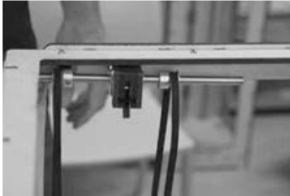
附录图 17 安装滑块与另一个同步轮
