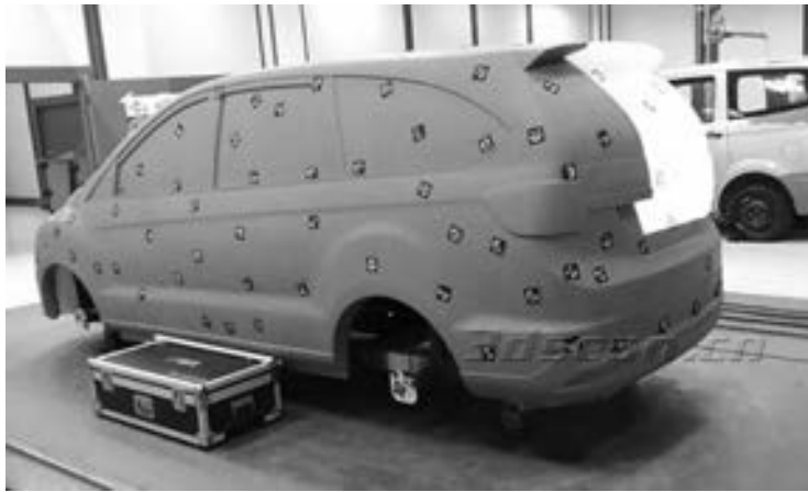
图 5-6 车壳油泥模型（图片来源：华朗三维）
