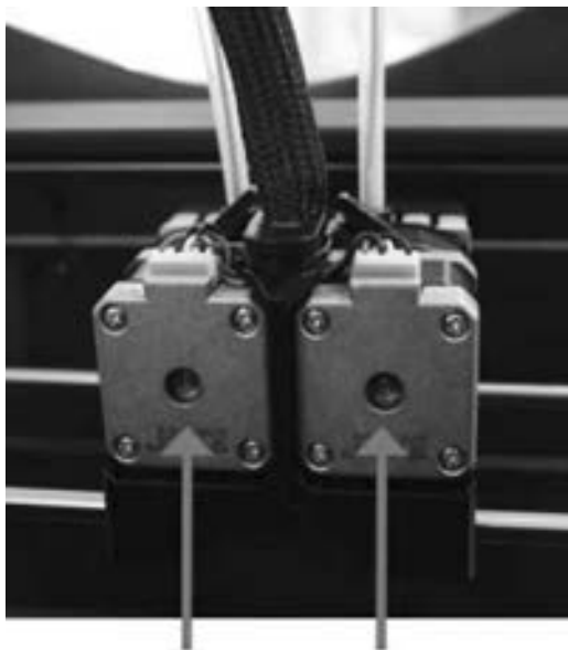
图 9-4 步进电动机轴（图片来源：www.makerbot.com）
