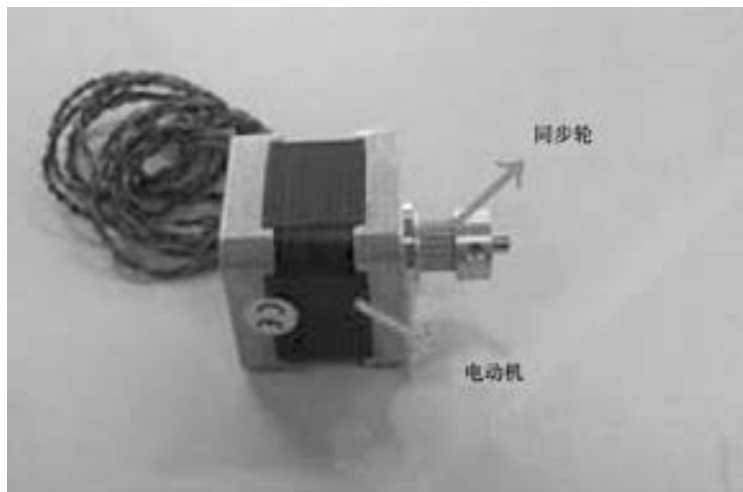
附录图 10 安装同步轮
