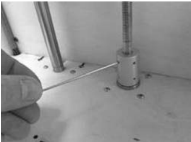
附录图 26 固定螺纹杆与联轴器
