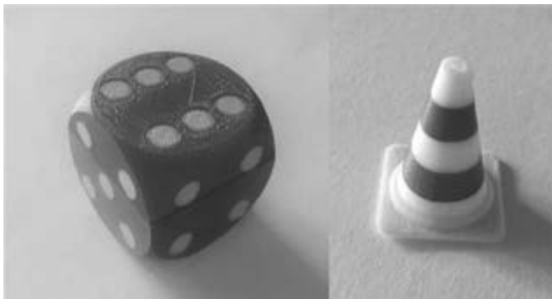
图 6-3 Pro/E 创建并打印完成的双色实体模型
