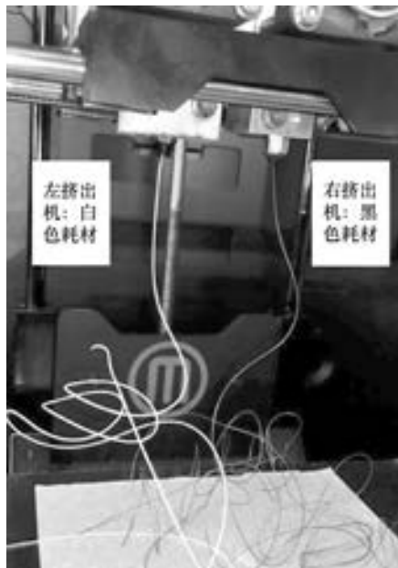
图 6-17 左、右挤出机出丝测试
