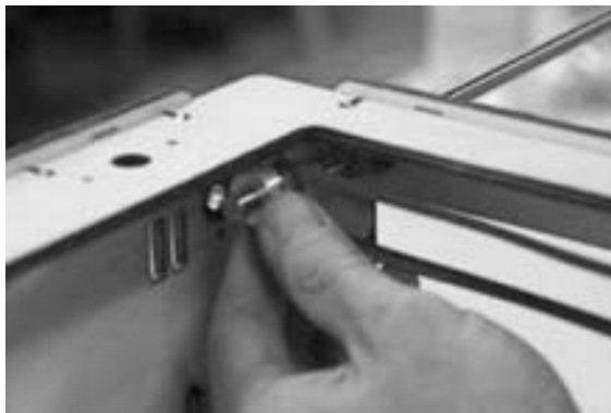
附录图 19 安装另一根短轴
