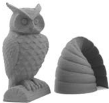
图 2-16 木质耗材 LAYWOO-D3 打印案例 (图片来源：中国 3D 打印网)
