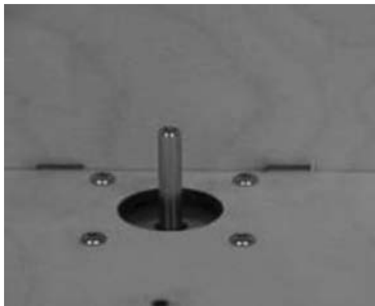
附录图 12 固定 Z 轴电动机
