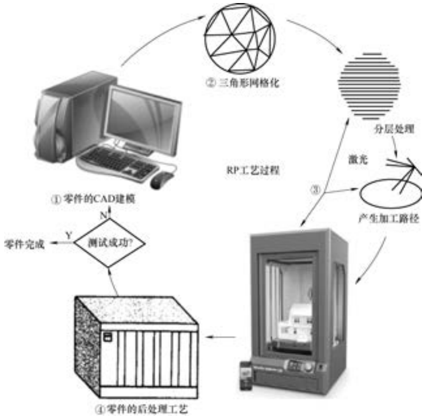
图 1-3 3D 打印技术原理
