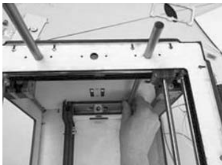
附录图 25 安装 Z 轴平台
