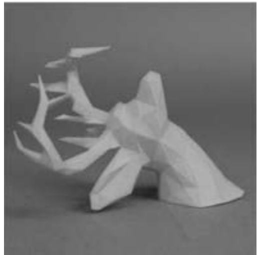
图 3-6 去除支撑后的模型
