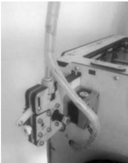
附录图 27 送料机安装完成后的效果
