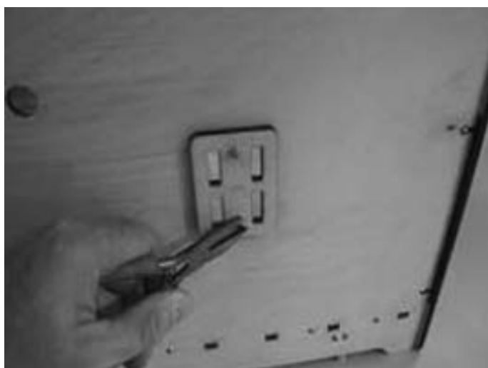
附录图 8 安装挂料机挡片
