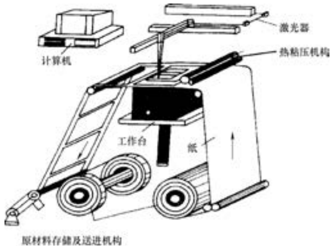
图 1-9 LOM 工艺的成型原理图 (图片来源: 数字化企业网)
