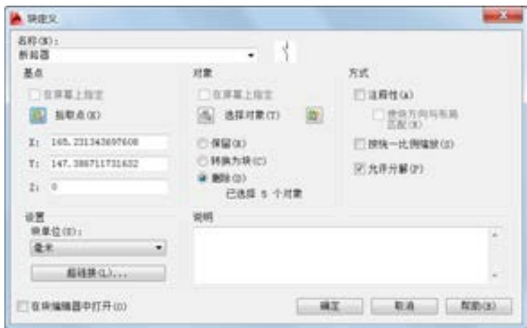
图 12-40 利用“块定义”对话框建立断路器图块
