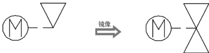
图 3-17 镜像示例（电动阀）
