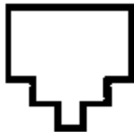
图 8-28 电话线图形符号
