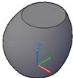
图 9-33 完成创建的放样实体
