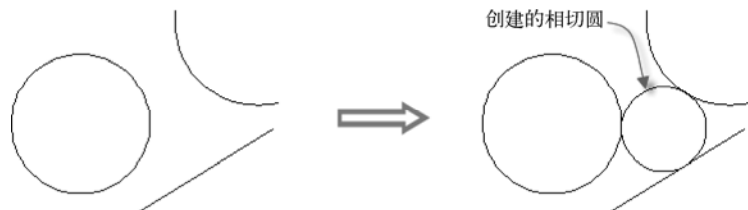
图 2-6 “相切、相切、相切”操作示例
