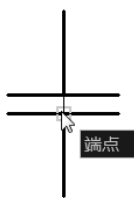
图 10-39 指定电容器一般符号块的插入点
