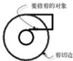
图8-86 修剪操作图解
