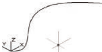
图 9-7 在三维空间中绘制样条曲线
