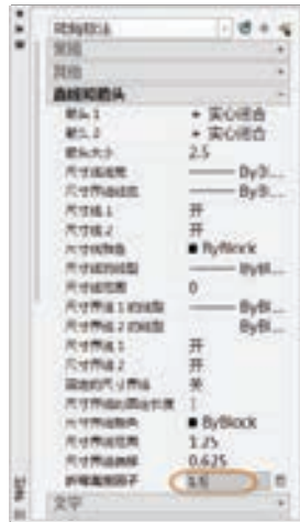
图 5-67 修改折弯高度因子
