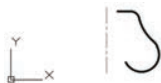
图 9-13 绘制中心线和二维多段线
