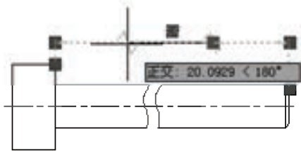
图 5-66 使用夹点调整折弯位置
