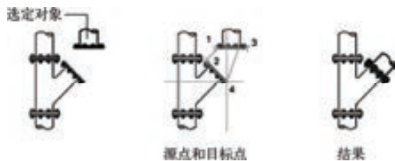
图9-112 在二维中利用两对点来对齐管道
