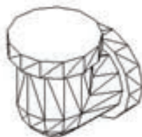
图 10-41 并集后的弯管主体
