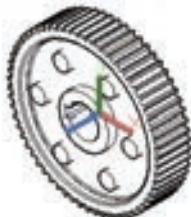
图 11-148 环形阵列圆柱体
