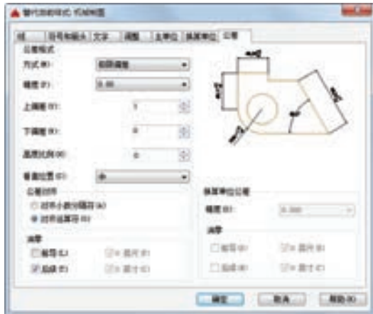
图 8-27 替代标注样式“公差”选项卡设置一
