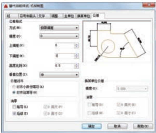
图 8-31 替代标注样式“公差”选项卡设置二
