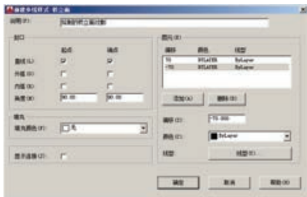
图 6-71 新建“桥立面”多线样式
