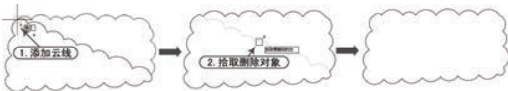
图 2-5 添加完成后删除云线操作
