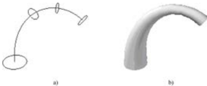
图 10-63 放样示例 a) 以路径曲线连接的横截面 b) 放样实体
