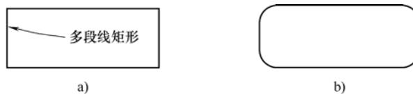
图 4-54 多段线对象的圆角
