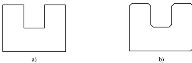
图 9-10 多线段倒角
