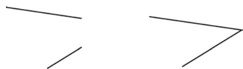
图 4-53 圆角半径为 0 时的圆角
