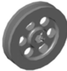
图 10-1 带轮的三维实体图
