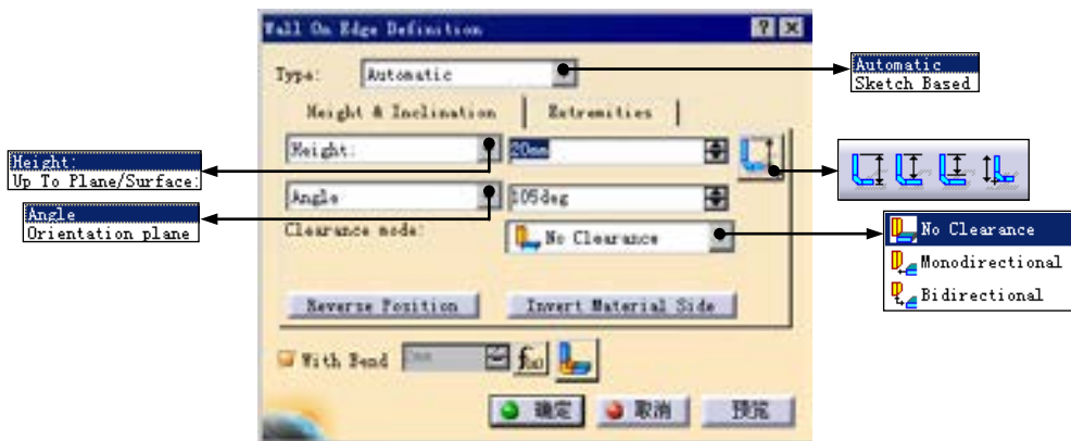
图 10.3.16 “Wall On Edge Definition”对话框
