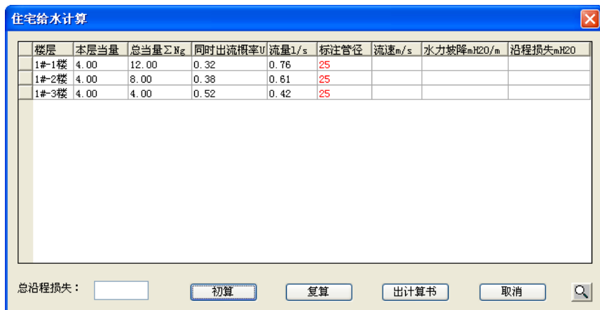
图 5-9 【住宅给水计算】对话框
