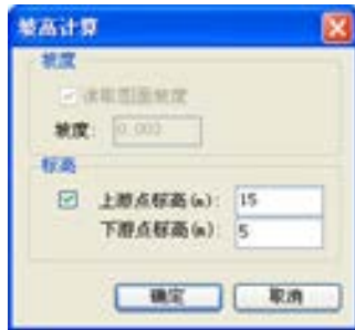
图 7-37 定义坡高参数
