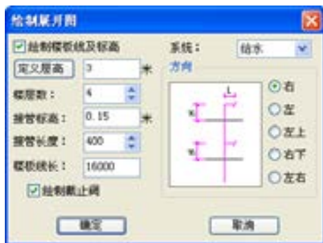
图 3-32 【绘制展开图】对话框
