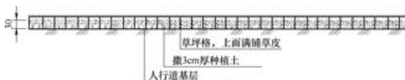
图 6-35 用于人行道的植草格基层构造示意图
