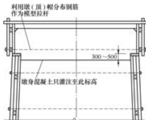
图 4-74 混凝土桥墩墩帽模板
