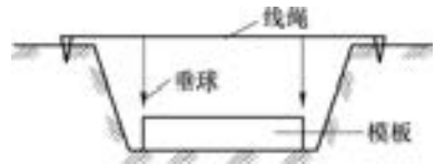
图 2-27 基础模板的防线
