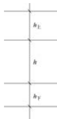
图 4-27 上下层层高与本层层高不同时对反弯点高度的影响
