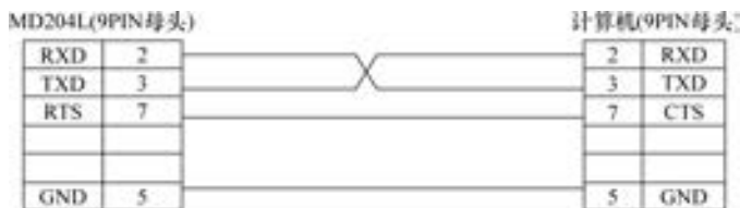
图 11-17 MD - SYS - CAB 连线图
