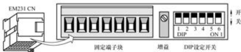
图 10-46 EM231 的校准和配置面板
