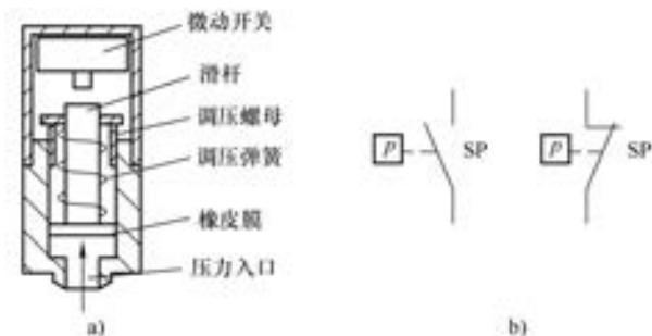
图 1-25 压力继电器结构及图形符号
