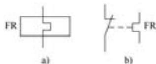
图 1-21 热继电器的图形及文字符号 a) 热元件 b) 常闭触点
