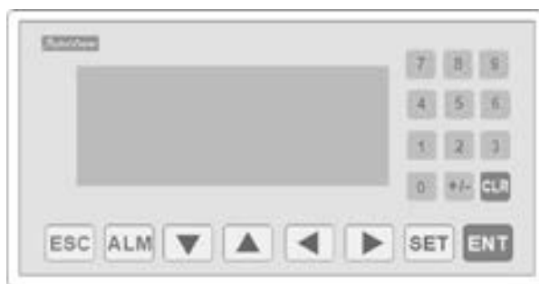
图 11-16 MD204L 可编程文本显示器的前面板
