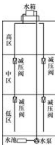
图 1-19 垂直立管循序减压给水方式
