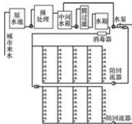
图 9-8 屋顶水箱重力供水方式
