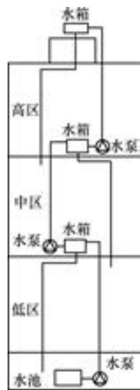
图 1-13 串联给水方式
