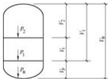
图 2-15 气压罐容积计算简图
