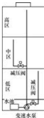
图 1-20 无水箱减压给水方式
