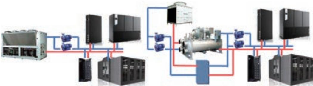
图 3-36 冷冻水型冷却系统原理图
