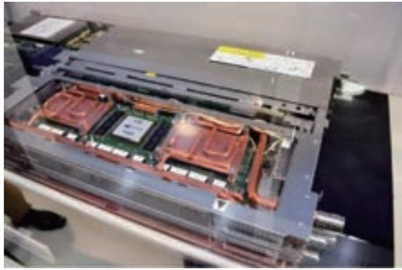
图 8-9 部分水冷式服务器
