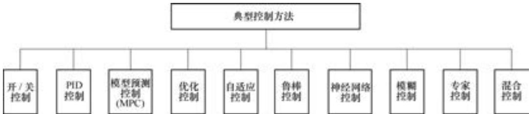
图 5-6 自动控制系统按控制方法的分类
