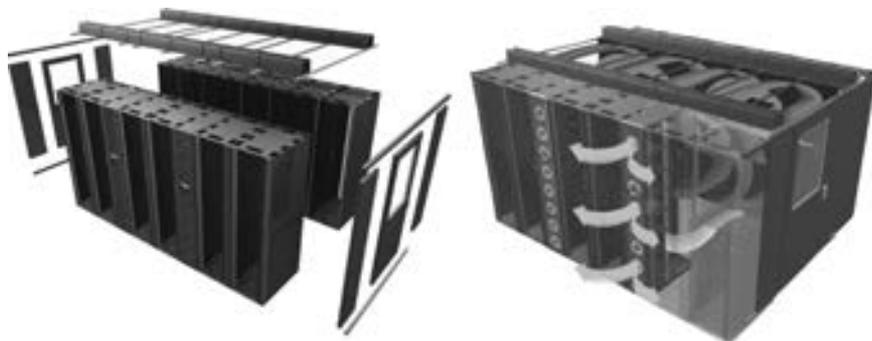
图 8-7 行间空调散热系统的组成和气流组织示意图（彩图见文前）
