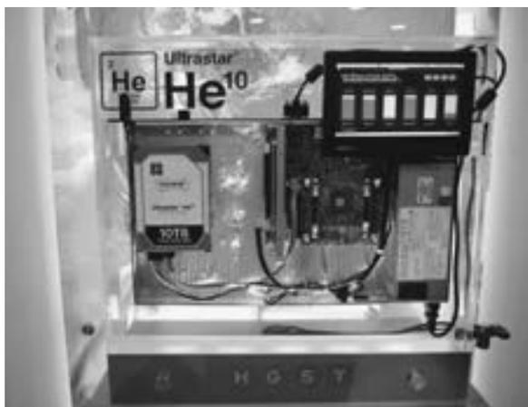
图 8-10 浸没式冷却样机（彩图见文前）
