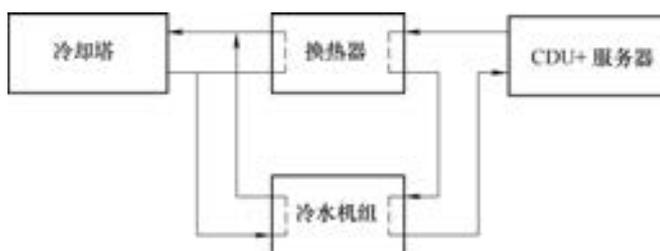
图 5-16 水侧省煤器的工作原理
