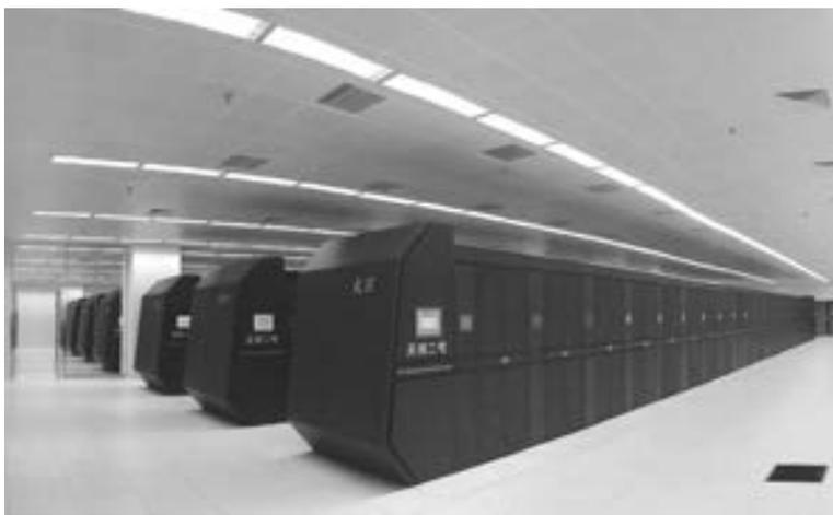
图 8-8 采用定制行间空调的天河 2 号超级计算机（彩图见文前）
