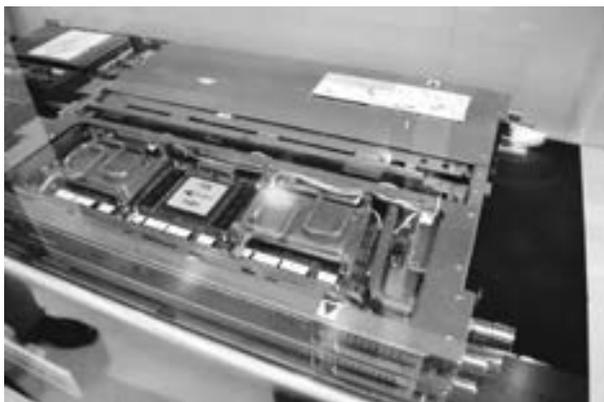
图 8-9 部分水冷式服务器（彩图见文前）
