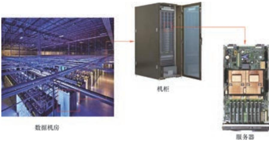
图 2-18 数据中心 IT 设备的构成与基本单元
