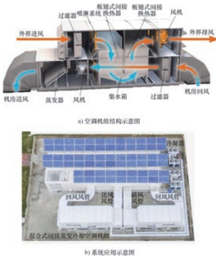
图 3-59 混合式间接蒸发冷却空调机组在数据中心冷却系统中的应用形式
