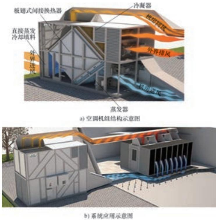
图 3-57 外冷式间接蒸发冷却空调机组在数据中心冷却系统中的应用形式
