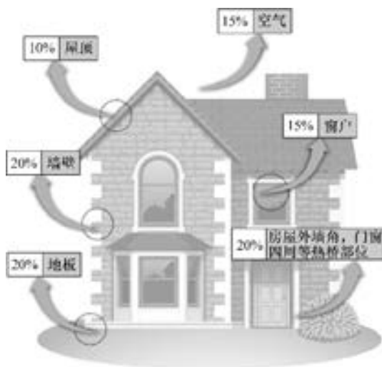
图 7-10 建筑热量流失的比例分布
