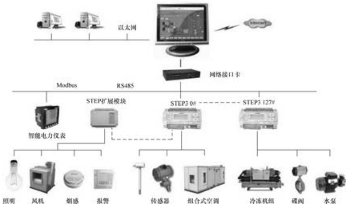
图 5-4 DDC 控制系统结构示意图
