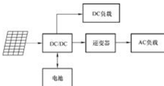
图9-17 独立光伏发电系统的组成原理
