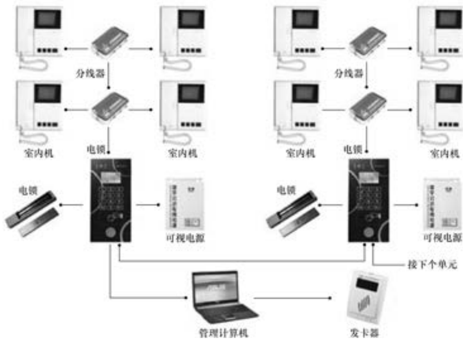
图 6-5 某对讲机 - 电锁门保安系统的结构
