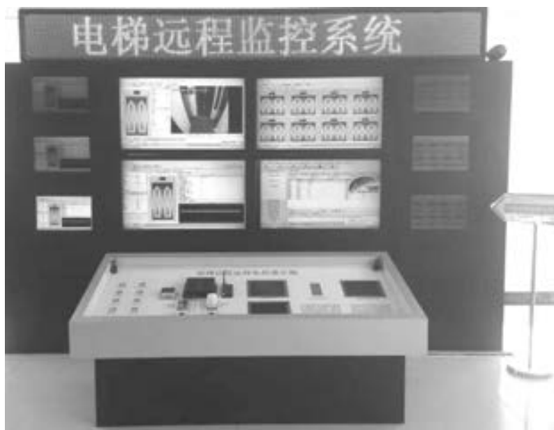
图 5-29 电梯远程监视系统示意图
