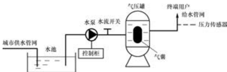
图 5-17 气压装置供水系统示意图
