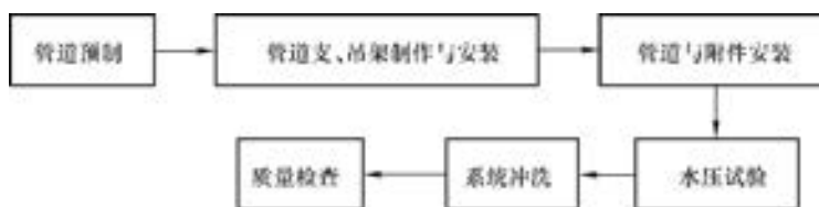
图 5-196 空调水系统管道与附件安装工序
