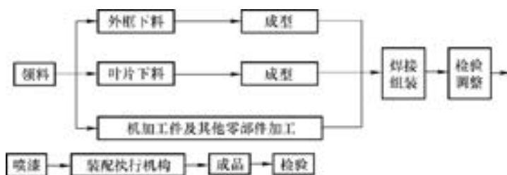
图 5-46 风阀制作工艺流程
