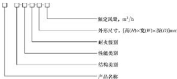
图 3-9 过滤器型号规格表示方法
