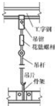
图 5-136 骨架与吊点连接
