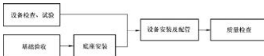
图 5-107 空气处理机组与空气热回收装置安装工序
