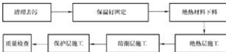
图 5-203 空调风管系统与设备绝热施工工序
