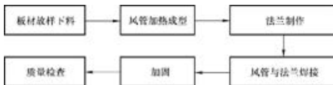
图 5-45 硬聚氯乙烯风管与配件制作工序
