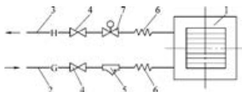
图 1-42 配管及附件示意图 (带电动二通调节阀)
