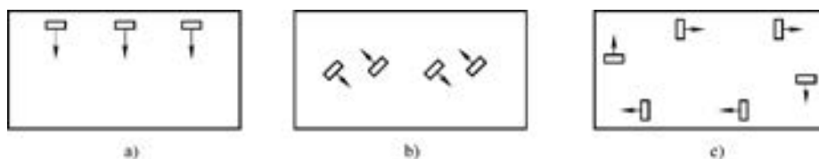
图 4-60 横吹式暖风机平面布置方案
