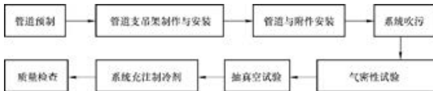
图 5-163 空调制冷剂管道与附件安装工序
