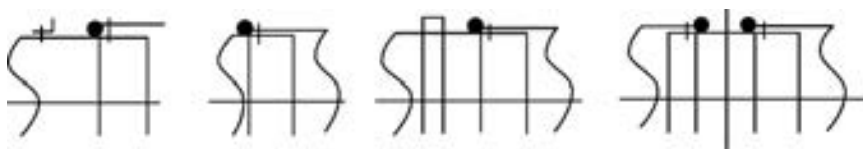
图 5-75 圆形风管连接的密封示意
