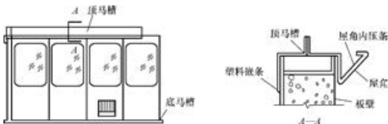
图 5-133 板壁安装示意图
