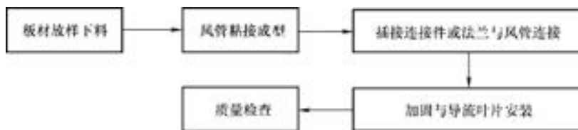
图 5-25 聚氨酯铝箔与酚醛铝箔复合风管及配件制作工序
