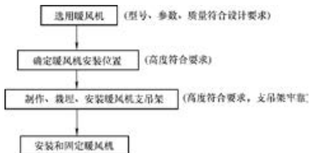
图 4-61 暖风机的施工顺序
