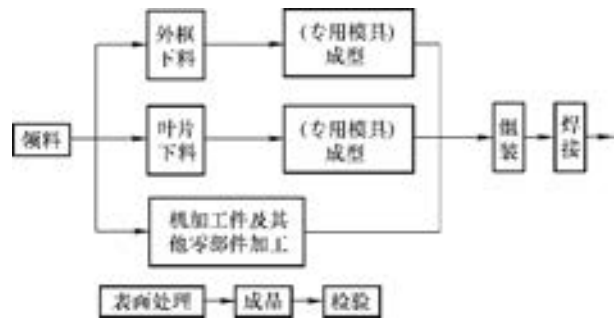
图 5-12 风口制作工艺流程
