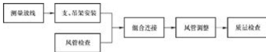
图 5-79 非金属与复合风管安装工序
