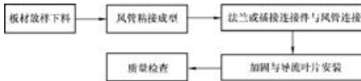
图 5-29 玻璃纤维复合风管与配件制作工序
