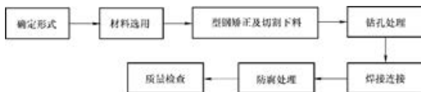
图 5-69 支、吊架制作工序
