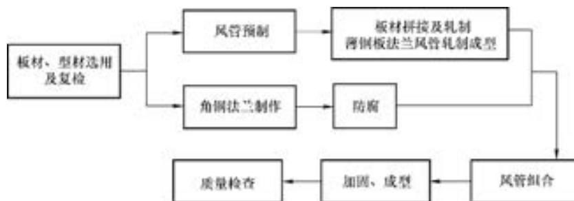
图 5-21 金属风管制作工序
