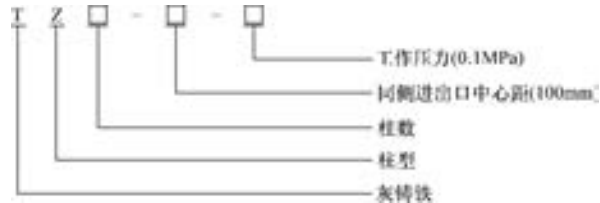
图 4-1 灰铸铁柱型散热器型号标记
