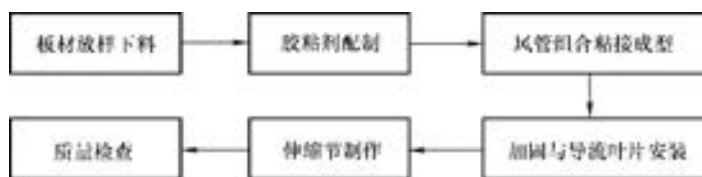
图 5-35 玻镁复合风管与配件制作
