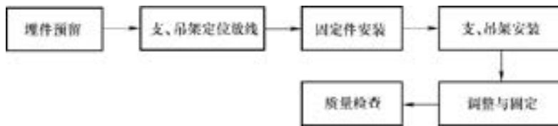
图 5-73 支、吊架安装工序
