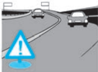
图5-13 故障车要在行驶方向的后方100m处放置警告标志
