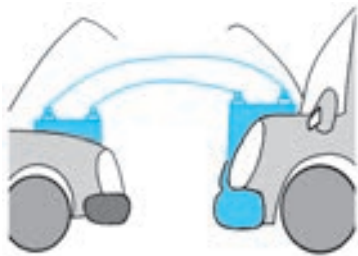
图 8-5 利用其他车上的蓄电池进行启动
