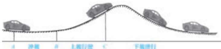
图 4-3 加速通过泥泞坡道
