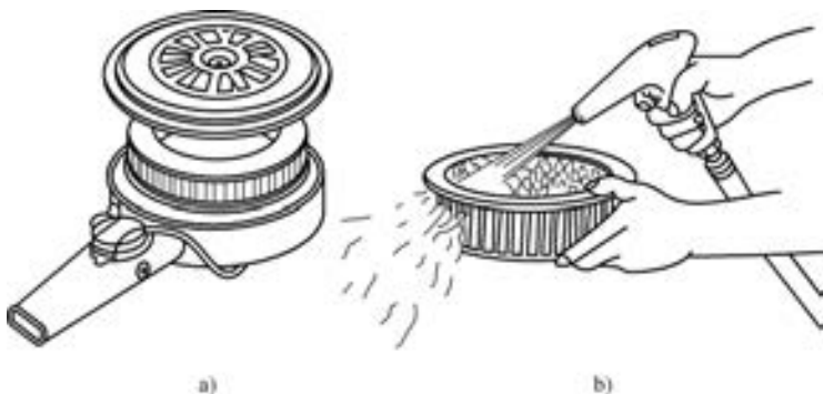
图 9-5 空气滤清器的清洁 a) 分解空气滤清器 b) 清洁滤芯
