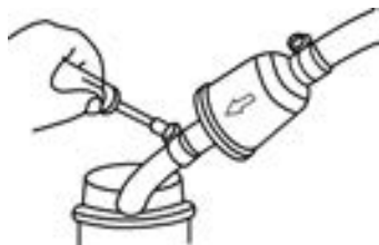
图 9-6 安装汽油滤清器
