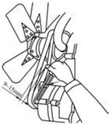
图 9-2 检查风扇传动带紧度
