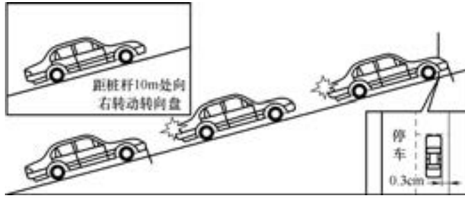
图 1-7 坡道定点停车和起步的操作要领
