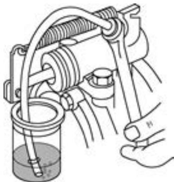
图9-20 工作缸的排气
