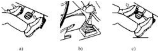
图 4-36 手动挡汽车的加挡
