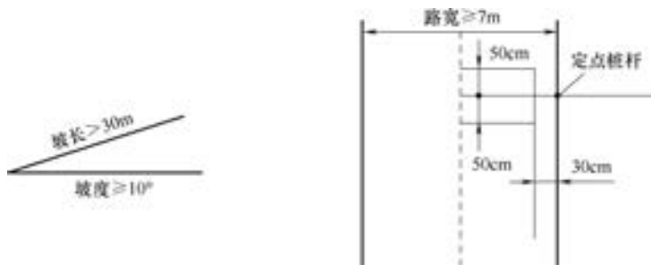
图 1-6 坡道定点停车和起步
