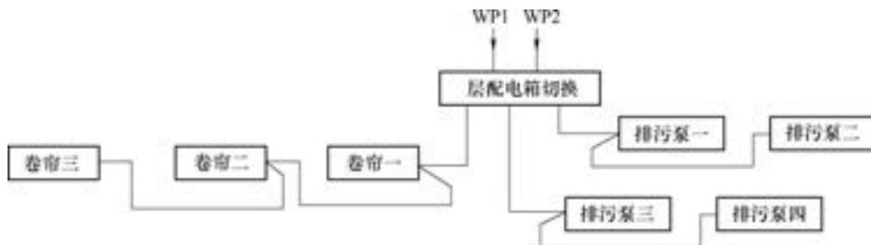
图 4-82 防火卷帘、排污泵的配电
