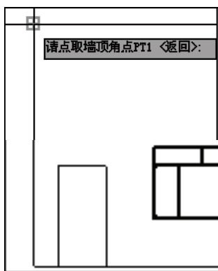
图 11-58 点取墙顶角点
