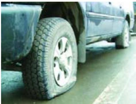
② 轮胎爆胎。高速行驶时若出现轮胎爆胎，车辆重心会倾向爆胎那一边，如果此时采取紧急制动，车辆可能向爆胎一侧滚翻，所以发现爆胎时，驾驶人应紧握转向盘，松抬加速踏板或制动踏板，千万不要紧急制动，极力控制行驶方向，必要时抢挂低速档，平稳驶离行车道。
