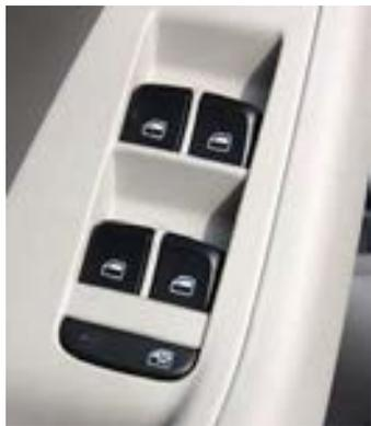
装有电动车窗的车，在各个车门都装有玻璃升降开关的按钮，向上拉玻璃上升，向下按玻璃下降。有的开关还可以点动，即轻点一下就可连续上升或下降。在驾驶人侧的车门上还有一个总开关，可以遥控各个车门玻璃的升降，还可关闭全车的玻璃升降机构。
