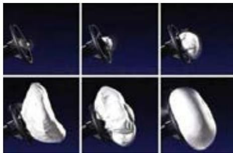
因为安全气囊的开发设计就是基于安全带有有限的保护作用之上的，安全带与安全气囊共同组成辅助乘员保护系统（SRS, Supplemental Restraint System），两者互相配合才能充分发挥对驾乘者的辅助保护作用。
