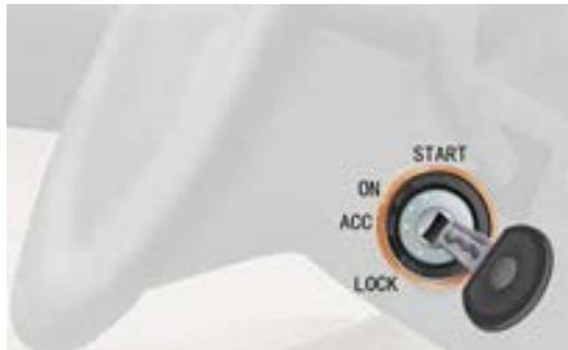
长时间停车时应将钥匙转到“LOCK”位置并拔出，临时停车时，可将钥匙转到“ACC”位置，这样可以继续使用各种汽车电器，比如收音机等。
