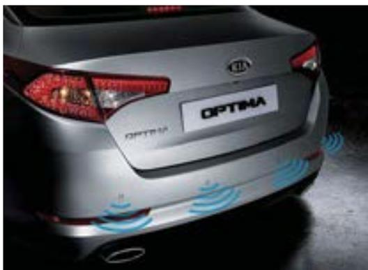
倒车雷达是根据蝙蝠在黑夜里高速飞行而不会与任何障碍物相撞的原理设计开发的。探头装在后保险杠上，根据不同的价格和品牌，探头有二、三、四、六、八、十、十二只不等。探头能够以最大水平 $120^\circ$ 、垂直 $70^\circ$ 的范围辐射，并上下左右搜寻目标。它最大的好处是能探索到那些因低于保险杠而使驾驶人从后窗难以看见的障碍物并报警，如花坛、路肩或蹲在车后玩耍的小孩等。
