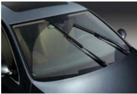
一般情况下，在汽车组合开关手柄上有刮水器控制旋钮，设有低速、高速、间歇3个档位。手柄顶端是洗涤器按键开关，按下开关喷出玻璃清洗液，配合刮水器洗涤风窗玻璃。
