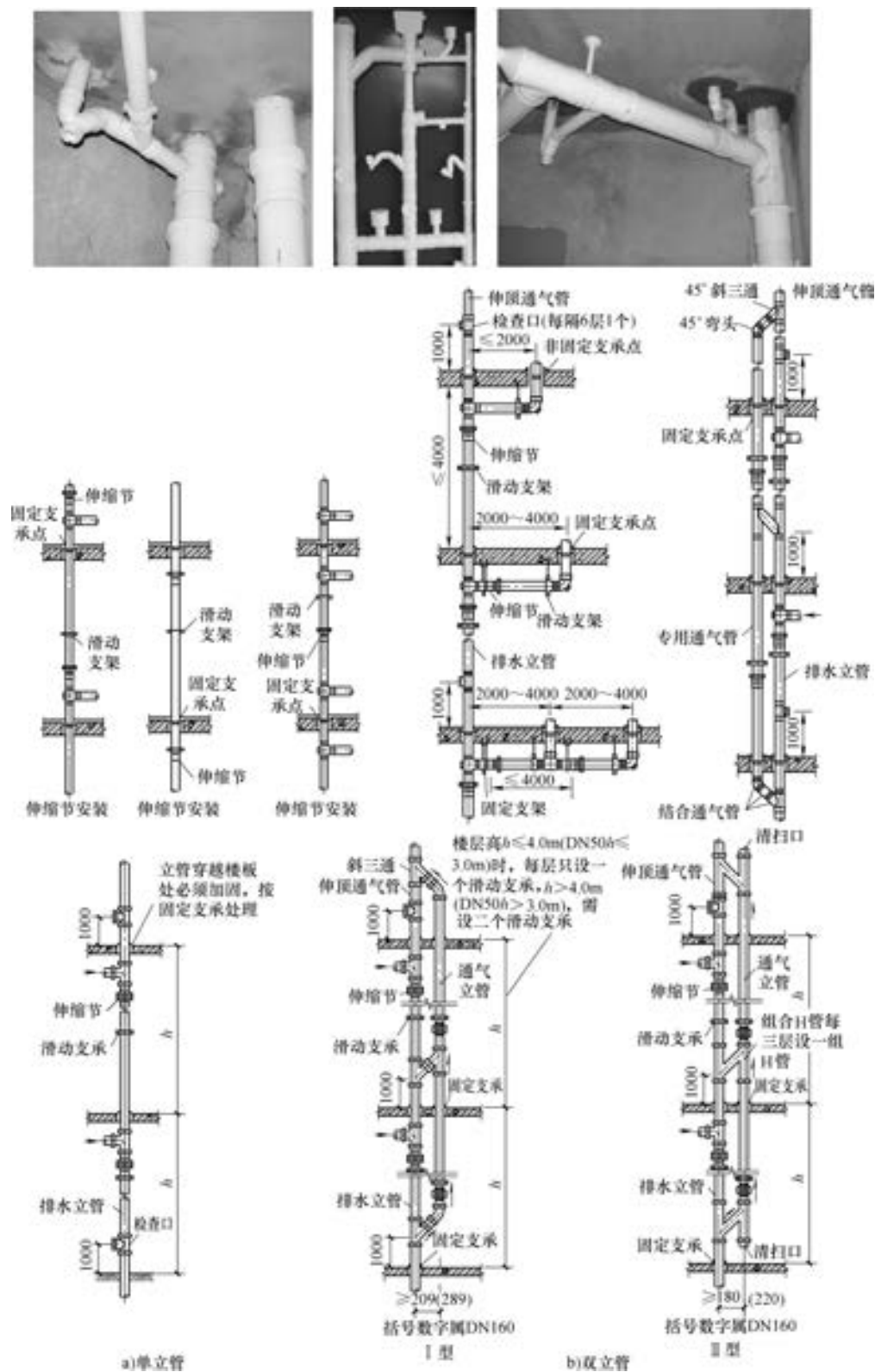
图 4-21 UPVC 排水管整体安装
