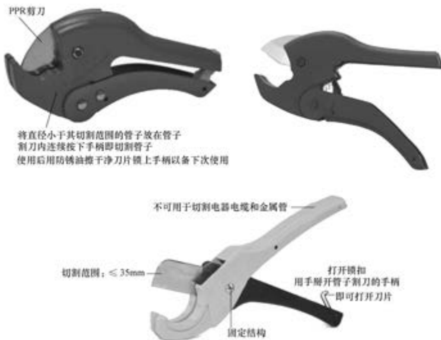
图 2-1 PPR 剪刀的外形结构
