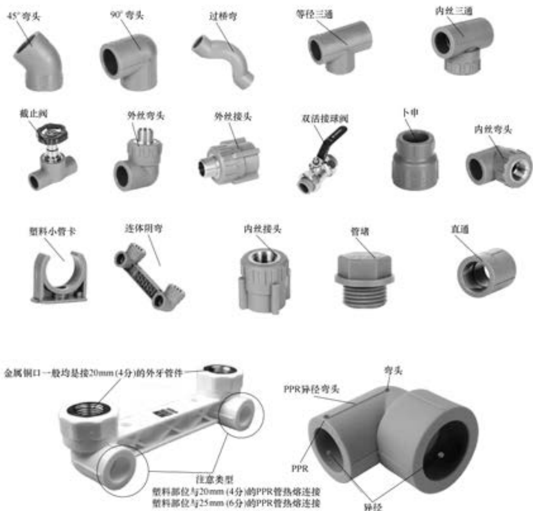
图 3-1 一些常见 PPR 冷热水管件（配件）
