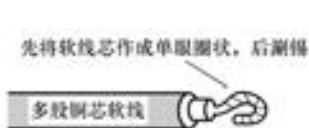
图 4-40 多股铜芯软线单眼圈
