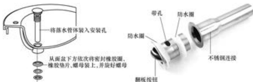
图 4-30 安装面盆下水器
