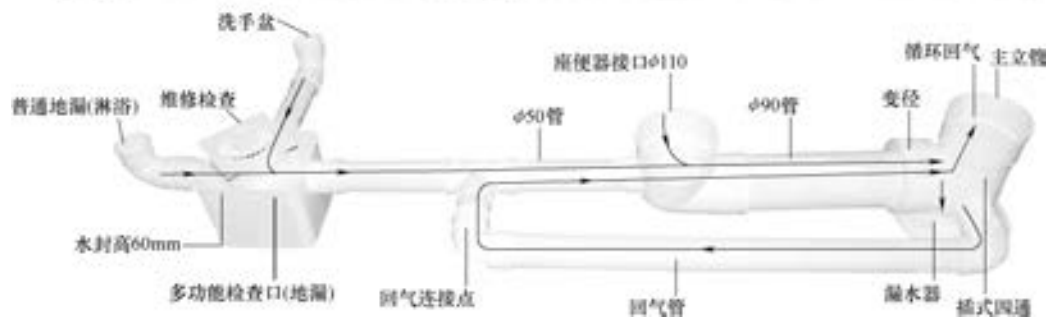
图 4-26 家居同层排水系统图例
