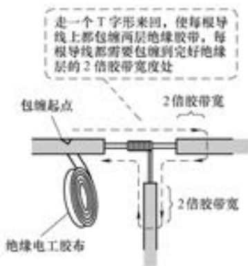
图 4-44 T 字分支接头绝缘处理
