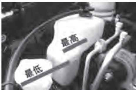
图11-33 制动液量的检查
