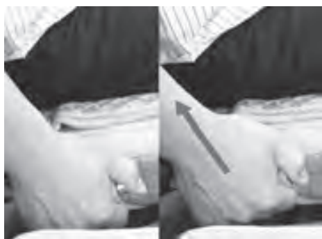
图6-12 驻车制动器的放下方法
