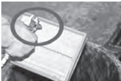
图11-30 清除空气滤清器中的脏污
