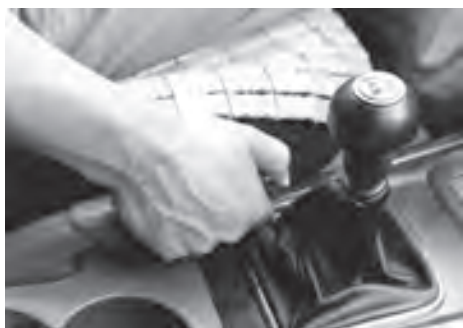
图11-34 查找驻车制动的有效工作点
