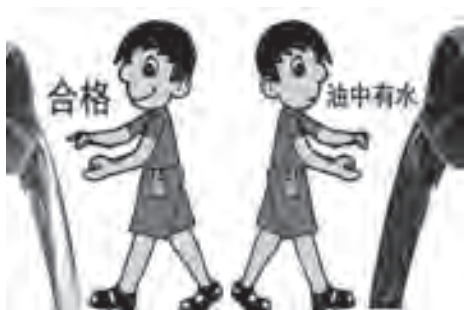
图11-29 检测机油中含水的直观方法
