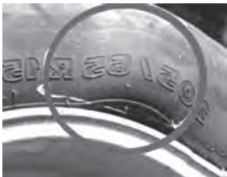
图11-37 轮胎的凸状磨损
