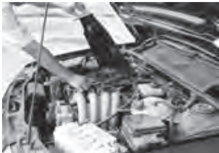
图11-25 检查发动机部分紧固件
