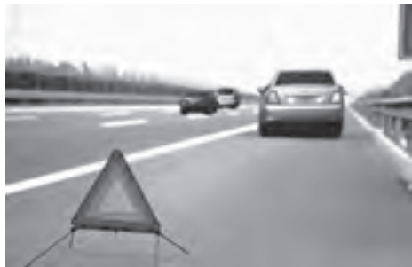
图6-28 放置故障车警告标志
