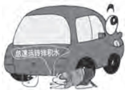
图11-47 消声器内积水的排除
