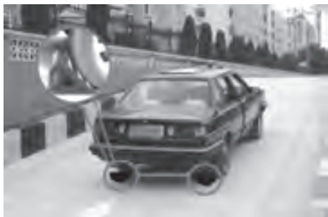
图6-19 坡道停车方法
