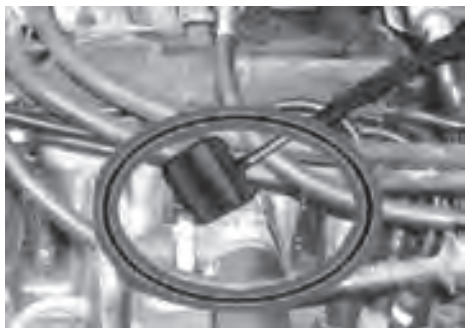
图8-5 用榔头轻轻敲击节温器
