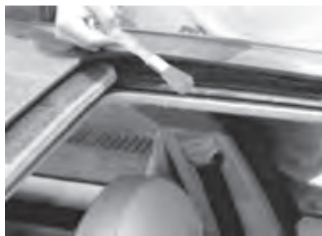
图11-43 定期清除车窗沟槽内的灰尘
