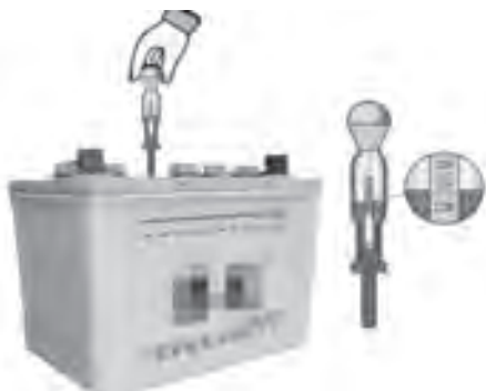
图11-14 蓄电池电解液密度检查
