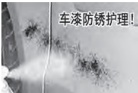
图11-15 及时进行防锈处理
