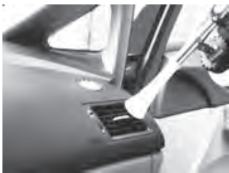
图11-13 对空调出风口的清洁维护
