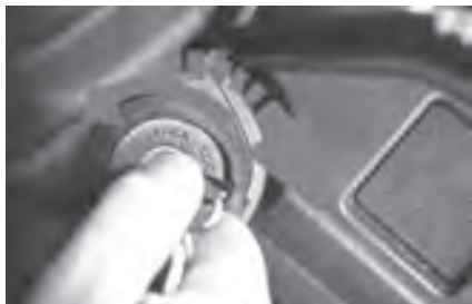
图9-2 连续起动伤蓄电池
