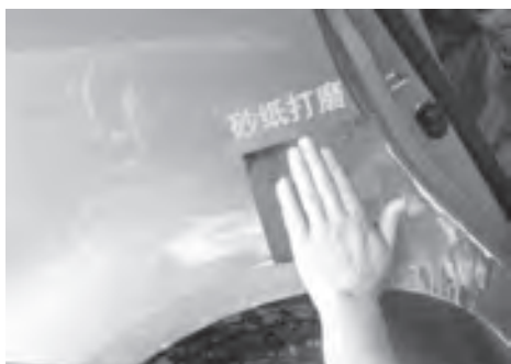
图11-46 砂纸打磨保险杠修补处
