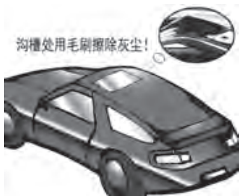
图11-45 及时清除天窗沟槽中的灰尘
